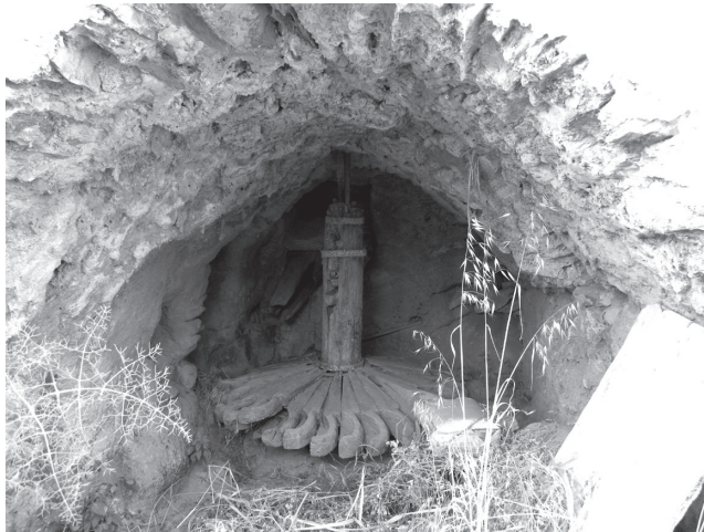
Figura 11: Rodezno o rodete de un molino harinero de acequia en el término municipal de Lújar.
