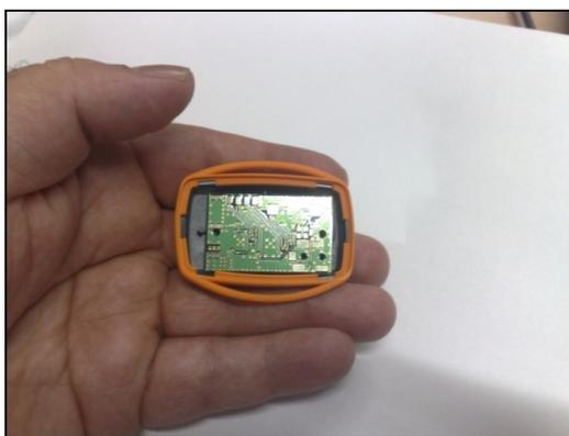
Figura 3. Acelerómetro triaxial con comunicaciones
