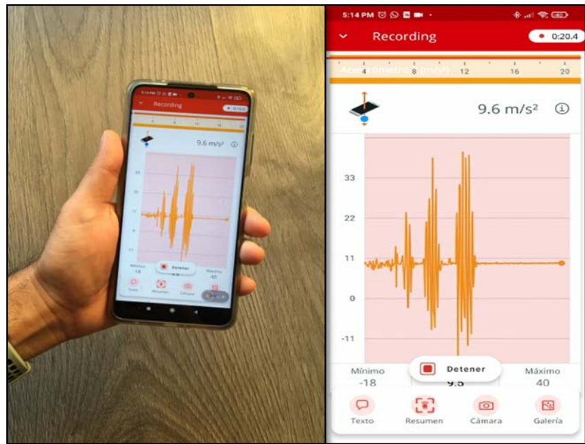
Figura 1. Medición de la aceleración utilizando la App Arduino Science Journal
